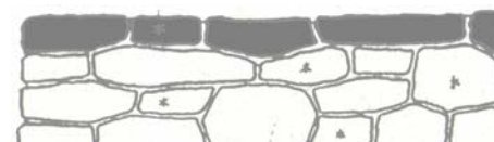
Decksteine satt aufliegend
